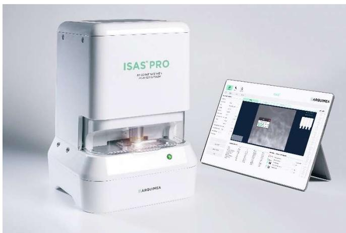
ISAS PRO es un sistema robotizado que analiza automáticamente la calidad del semen, evaluando simultáneamente la motilidad, morfología y concentración.
